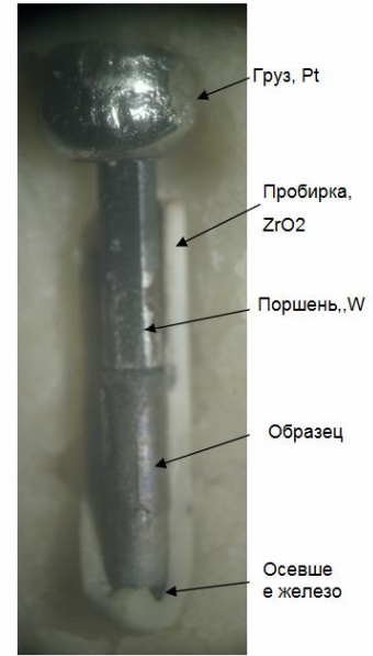
Измерительная ячейка центрифуги с W поршнем и Pt грузом. CS-120
