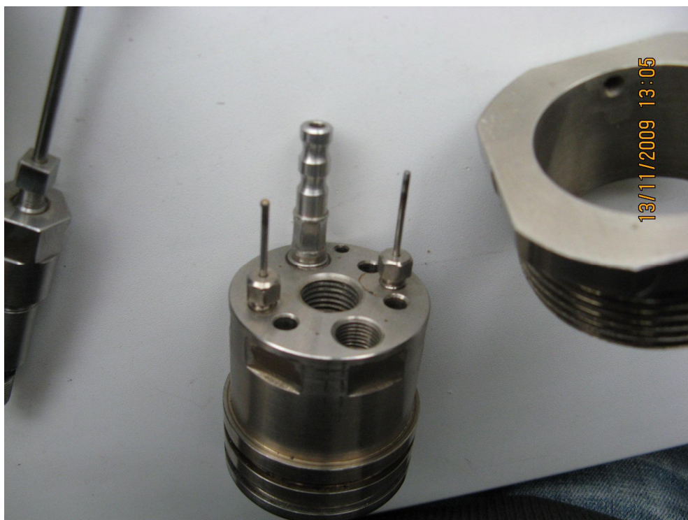
Рис. 2. Оголовок потенциметрической ячейки с отверстиями для электродов и пробоотборника.
